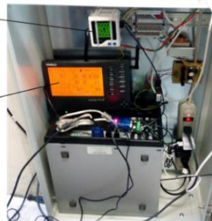
Modulo sensorial para el monitoreo de energía eléctrica generada
