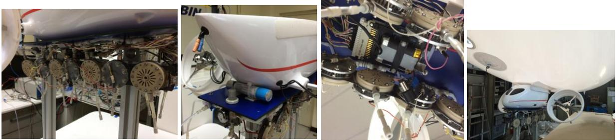
**Fig. 5.** De izquierda a derecha: stack de alimentación pasiva, almacenamiento de hidrógeno, tarjeta de colección de datos, y vista de la góndola con todos sus componentes.
