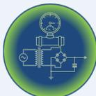
Sistema auxiliar: válvula de presión para H<sub>2</sub> (0.5bar) y convertor dc-dc a 2 V.
