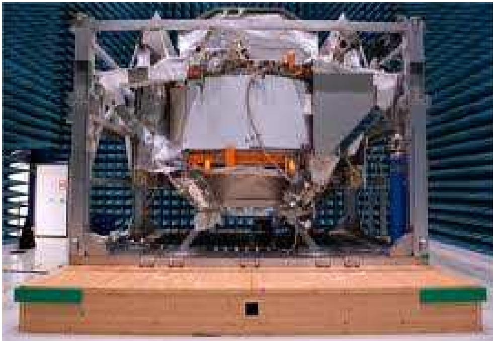
Figura 2.18: AMS-02 en la sala de pruebas de Test de Niveles de Interferencia Electromagnética, en las instalaciones de la ESA, en ESTEC (Holanda).
