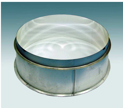
Figura 3.7: Espejo reflector del RICH de AMS-02, que está compuesto por tres secciones.
