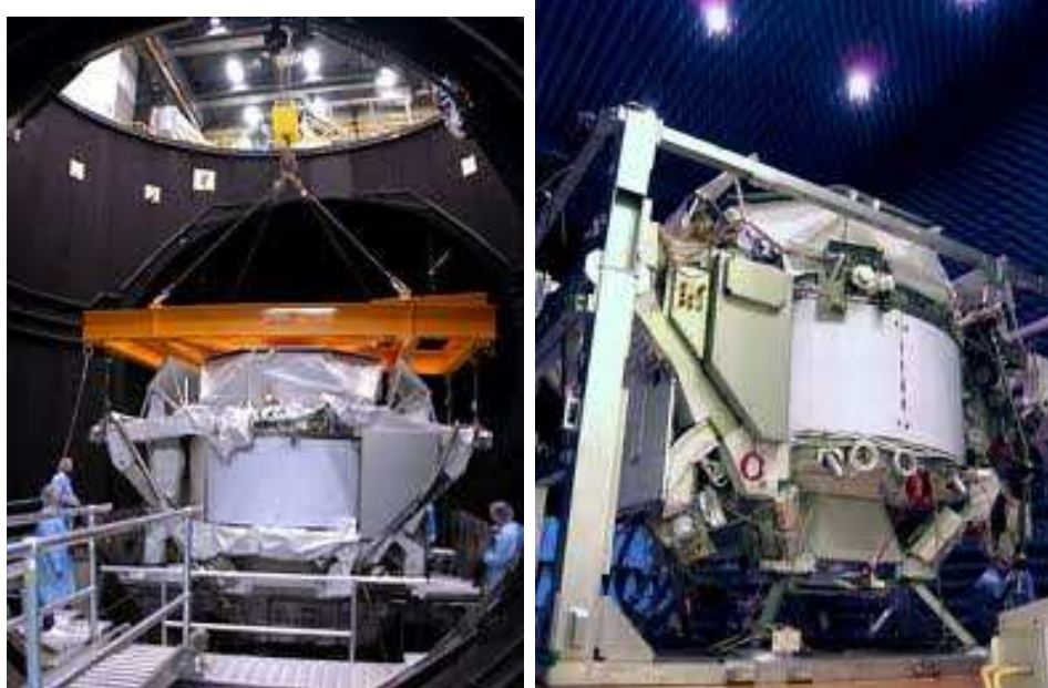
Figura 2.16: AMS-02 en la sala de pruebas de Vacío y Térmicas en las instalaciones de la ESA, en ESTEC (Holanda).
