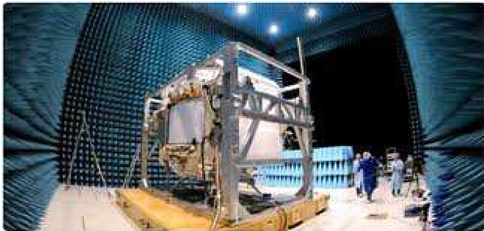
Figura 2.17: AMS-02 en la sala de pruebas de Test de Niveles de Interferencia Electromagnética, en las instalaciones de la ESA, en ESTEC (Holanda).
