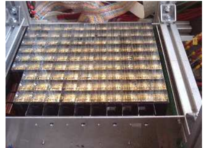
Figura 3.2.: Detalle del plano de detección del prototipo del RICH de AMS.
