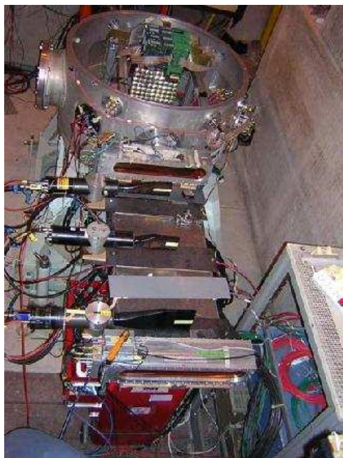
Figura 5.2: Vista superior del prototipo situado en el SPS. Se puede ver la matriz de los PMs del prototipo dentro del contenedor cilíndrico abierto. Asimismo se pueden ver la cámara de hilos y las barras de plástico centelleador utilizadas para el trigger .
