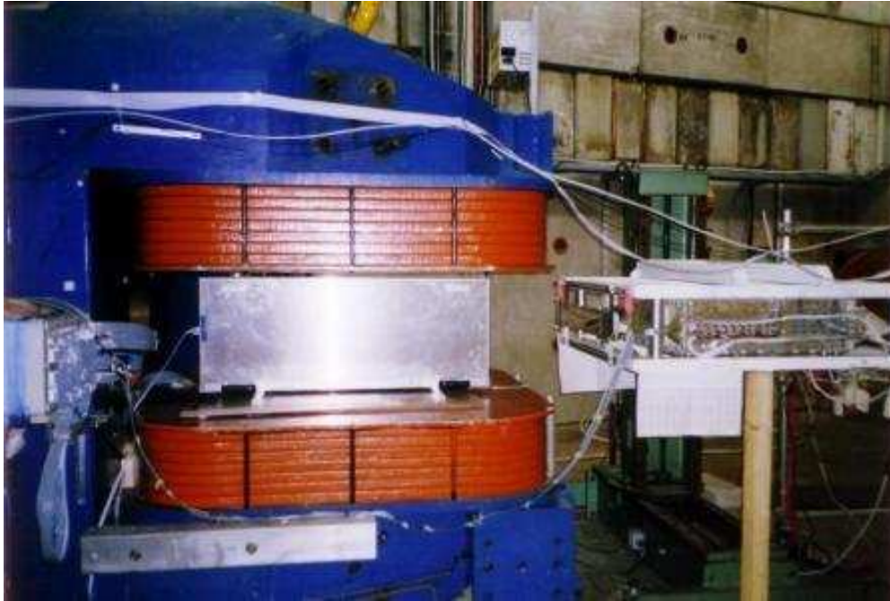
Figura 4.6: Detectores STD2, STD3 y ECALD. Vista lateral.
