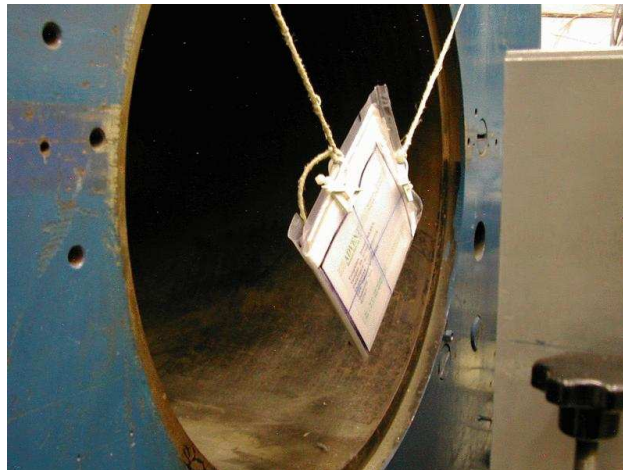
Figura 4.8: Convertidor de tungsteno, situado entre el STD1 y STD2, situado a la entrada de la estructura del imán.
