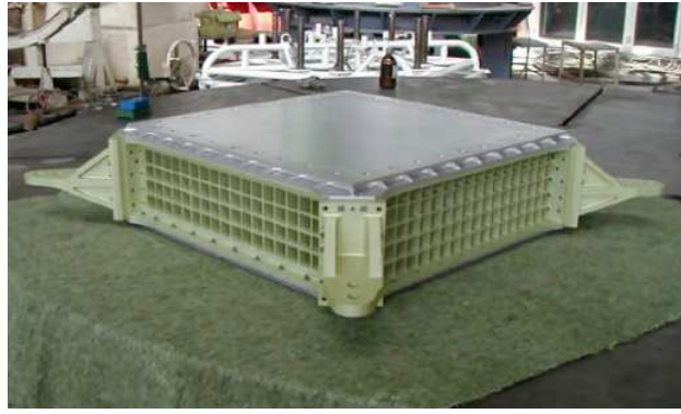
Figura 2.15: La estructura del soporte mecánico del ECAL.
