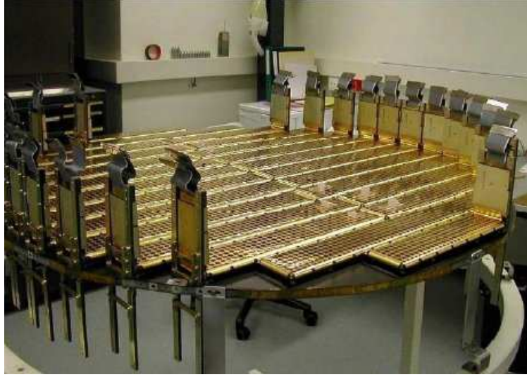
Figura 2.9: Primer nivel del STD instrumentado en la sala limpia de la Universidad de Ginebra. Consta de 24 módulos ya preparados y envueltos con el shielding electromagnético.
